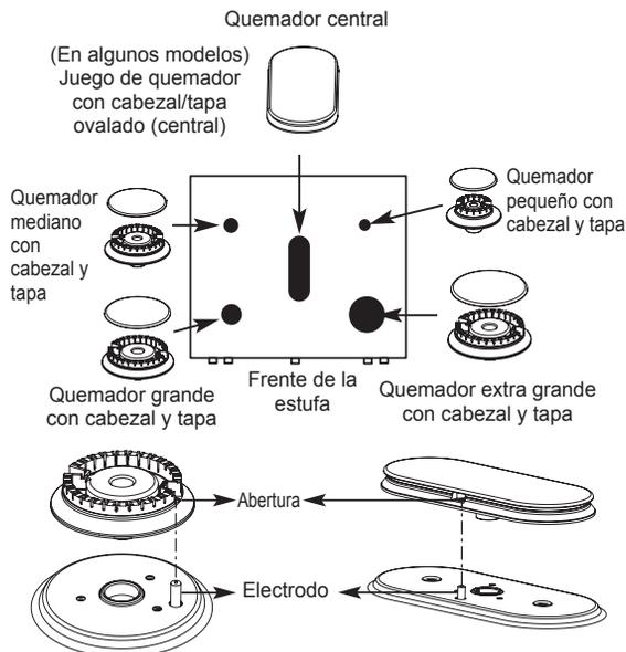
Asegúrese de que el agujero del cabezal del quemador esté ubicado sobre el electrodo.
