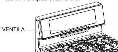
**No cubra la superficie de la placa de cocción con papel de aluminio. Bloquear la ventila del horno puede dañar el panel de control.**
