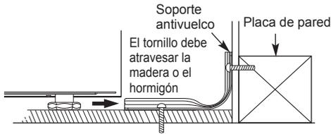
Se incluye un soporte antivuelco con una plantilla de instalación. Las instrucciones incluyen la información necesaria para completar la instalación. Lea y siga la hoja de instrucciones de instalación de la estufa.
