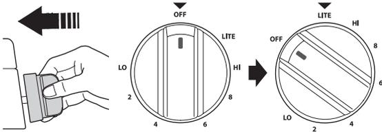
El sistema de encendido por chispa eléctrica hace un clic. Una vez encendido el quemador, gire el mando en sentido anti horario hasta la posición **HI** para dejar de oír el ruido del clic.
