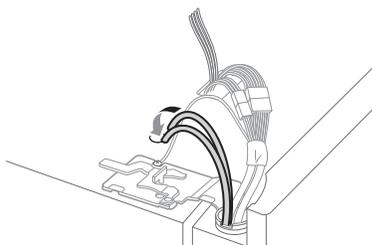
5 Sujete la conexión de suministro de agua y empuje gentilmente la pinza ④ para conectar la línea de suministro de agua como se muestra. Introduzca un tubo de al menos 5/8 pulgadas (15 mm) en el conector. Introduzca el clip en el área de unión para asegurar el tubo en su lugar.
