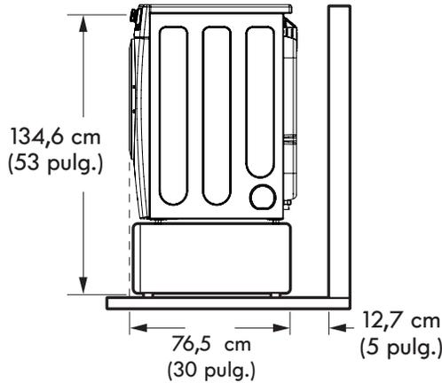
Dimensiones requeridas para la instalación con el kit para montaje sobre la lavadora
