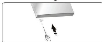
10. Remplacez les trappes de vis en faisant passer du côté gauche au côté droit (comme sur l'illustration ci-dessous).
