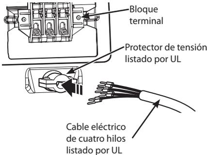
• Instale un cable eléctrico de **30 A, 240 V, listado por UL con un conductor de cobre Núm.-10 AWG** como mínimo y terminales de bucle cerrado o de horquilla con extremos doblados hacia arriba.
