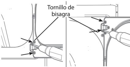
3. Con la puerta colocada sobre una superficie protegida, retire los 16 tornillos de cada lado de la puerta y retire el panel interior de la puerta con un destornillador de punta plana. Retire el enganche y la pieza, y llévelas al lado opuesto.
