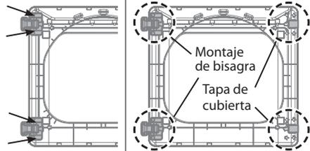
5. Con las bisagras y los rellenos en la nueva posición, monte de nuevo el panel interior de la puerta en la estructura de ésta con los tornillos retirados en el paso 3 anterior.
