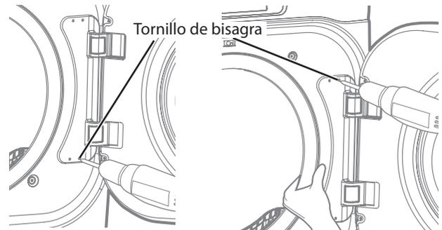
6. Retire la puerta de la parte frontal de la secadora.
