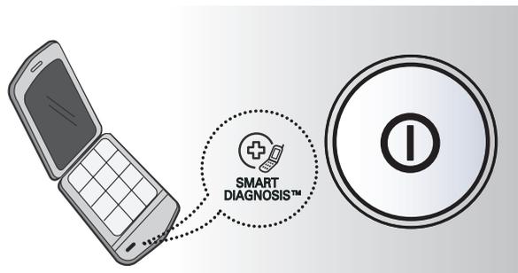
3. Mantenga pulsado el CONTROL DEL TEMPERATURA(TEMP.CONTROL) botón durante tres segundos, mientras que mantiene el auricular del teléfono junto al icono o botón ENCENDIDO/APAGADO (POWER).
