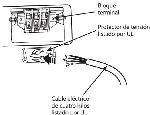
• Instale un cable eléctrico listado por UL con **4 conductores de cobre Núm.-10 AWG como mínimo.**
