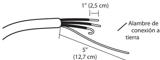
2. Quite la cubierta de acceso al bloque terminal localizado en la parte superior trasera de la secadora. Instale un protector de tensión listado por UL en el orificio de pase del cable eléctrico; luego pase el cable eléctrico fabricado en el Paso 1 por el protector de tensión.
