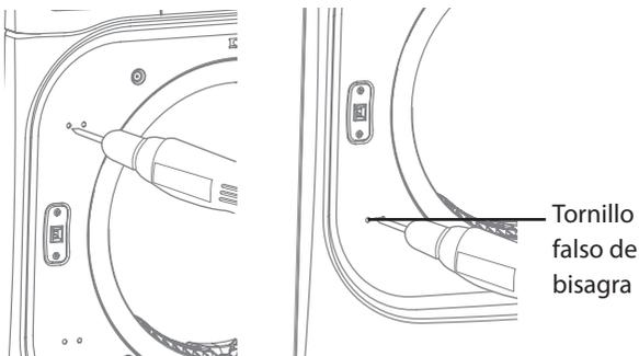
4. Retire dos tornillos y extraiga la placa de cierre.
