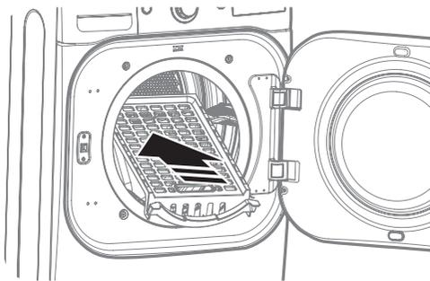
2. Asegúrese de que esté asentado uniformemente sobre el borde interior de la puerta y descance horizontalmente sobre el interior de la secadora.
