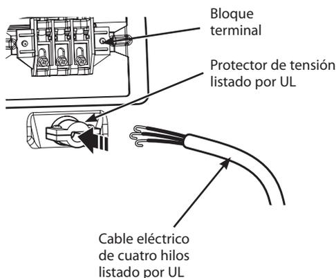
• Instale un cable eléctrico listado por UL con **3 conductores de cobre Núm.-10 AWG como mínimo**.
