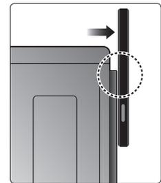
Cuando utilice la función Tag On, coloque su teléfono inteligente de manera que la antena de NFC en la parte trasera del teléfono sea igual a la posición del ícono de Tag On en el electrodoméstico. Si no conoce la posición de su antena NFC, mueva su teléfono inteligente suavemente haciendo un movimiento circular hasta que la aplicación verifique la conexión.
