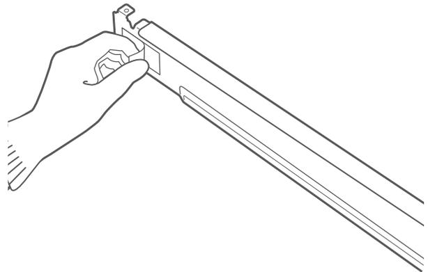
2. Haga coincidir la abrazadera lateral del lado de la parte superior de la lavadora como se indica en la ilustración anterior. Apriete firmemente el área adhesiva de la abrazadera a la superficie de la lavadora. Asegure la abrazadera lateral a la lavadora con un tornillo en su lado trasero. Repita los pasos 1 y 2 para conectar la abrazadera del otro lado.
