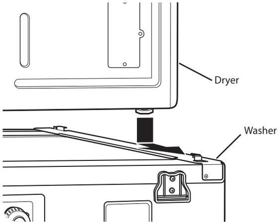
4. Insterte el riel frontal entre la parte inferior de la secadora y la parte superior de la lavadora. Empuje el riel frontal hacia la parte trasera de la lavadora hasta que entre en contacto con los topes del riel lateral. Instale los dos tornillos restantes para asegurar el riel frontal a los laterales.
