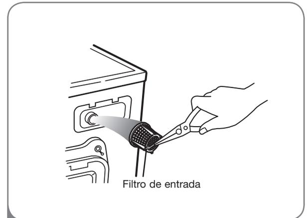
**2** Quite cuidadosamente los filtros de las entradas de agua, luego remójelas en vinagre blanco o un eliminador de depósitos calcáreos, siguiendo las instrucciones del fabricante. Enjuague profundamente antes de reinstalar.
