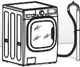
Conexión del tubo de desagüe
