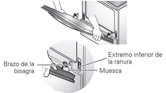
2. Con la puerta en el mismo ángulo que la posición de extracción, coloque la Muesca del brazo de la bisagra en el borde inferior de la ranura de la bisagra. La Muesca en el brazo de la bisagra debe estar completamente asentado en la parte inferior de la ranura.
