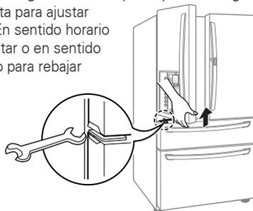
La puerta derecha del refrigerador no tiene una tuerca ajustable.
