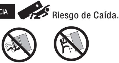
Los modelos con estilo incorporado (modelo PYE, CYE, y PWE) son inestables, especialmente con las puertas abiertas. Estos modelos deben ser asegurados con el soporte anti-volcaduras, a fin de evitar caídas hacia adelante, que podrían resultar en la muerte o lesiones graves. Lea y siga las instrucciones de instalación en su totalidad, a fin de instalar el soporte de piso anti-volcaduras embalado con su refrigerador.
