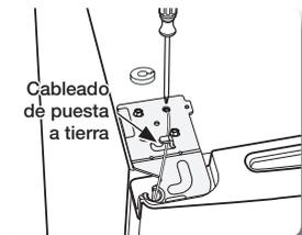
7. Introduzca y apriete el perno de puesta a tierra en las bisagras superiores izquierda y derecha mediante un destornillador Philips (+).
