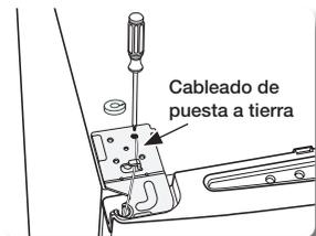
4. Extraiga el perno que sujeta el cableado de puesta a tierra mediante un destornillador Philips (+).
