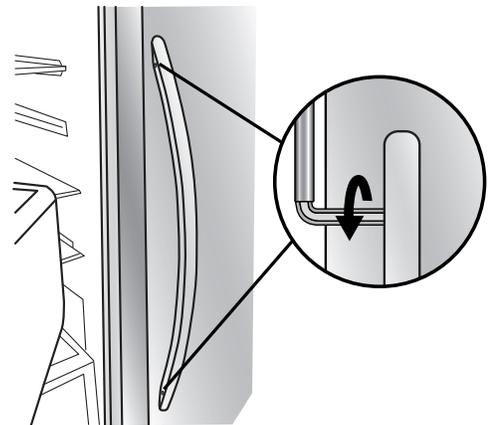
5. Con un movimiento de reloj, apriete el tornillo opresor hasta que comience a hacer contacto con el tornillo de tope.
