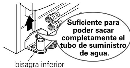
6. Coloque la puerta, con el interior hacia arriba, sobre una superficie que no raye. Tenga cuidado de no dañar el tubo de alimentación de agua.
