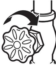
Corte la válvula de agua después de que haya pasado aproximadamente un litro de agua a través de la tubería.
