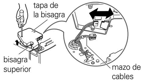
1. Abra la puerta. Retire el tornillo de la tapa de la bisagra superior.
