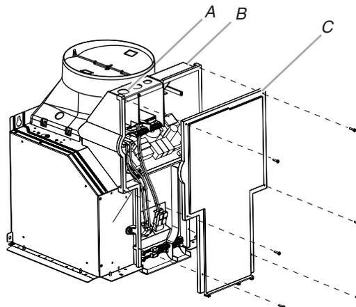
4. Acheminer le cordon d'alimentation du domicile à travers le serre-câble, dans le boîtier de connexion.
