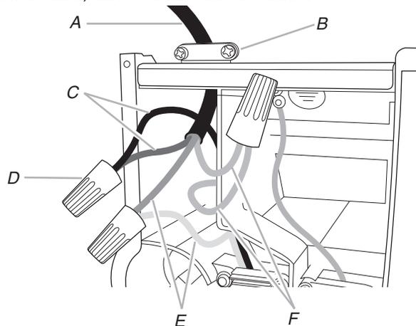
5. Connecter ensemble les conducteurs noirs (C) à l'aide de connecteurs de fils (homologation UL).
