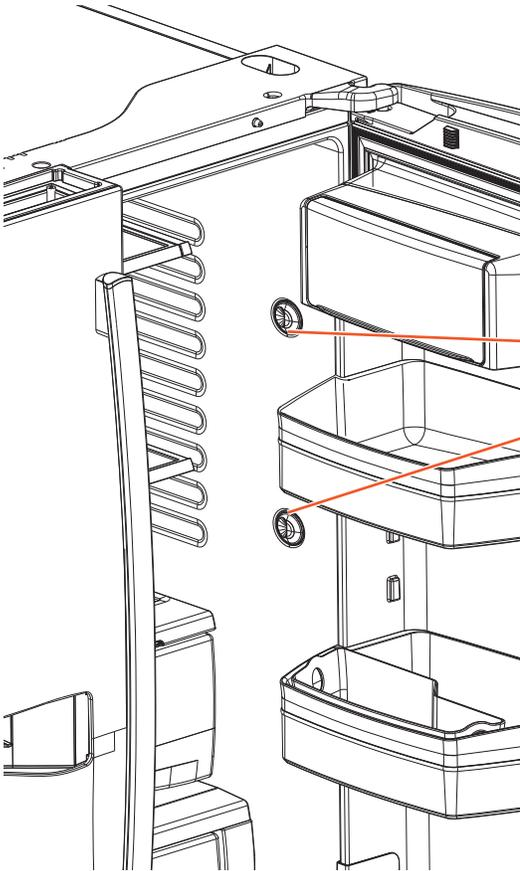
Hay una luz LED en el compartimento de comidas frescas y en la parte inferior de las puertas de comidas frescas para iluminar el compartimento del freezer.\*
