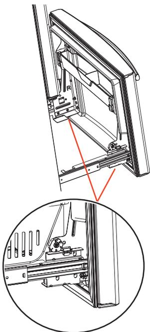
**A** Ubique la leva de ajuste de altura en la puerta del freezer. Lentamente afloje los tres tornillos de ajuste de la puerta a ambos lados usando un destornillador con cabeza hueca hexagonal de 3/8".
