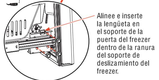
Alinee e inserte la lengüeta en el soporte de la puerta del freezer dentro de la ranura del soporte de deslizamiento del freezer.
