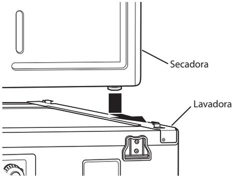
4. Insterte el riel frontal entre la parte inferior de la secadora y la parte superior de la lavadora. Empuje el riel frontal hacia la parte trasera de la lavadora hasta que entre en contacto con los topes del riel lateral. Instale los dos tornillos restantes para asegurar el riel frontal a los laterales.
