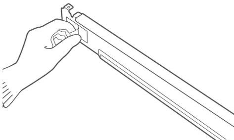
2. Haga coincidir la abrazadera lateral del lado de la parte superior de la lavadora como se indica en la ilustración anterior. Apriete firmemente el área adhesiva de la abrazadera a la superficie de la lavadora. Asegure la abrazadera lateral a la lavadora con un tornillo en su lado trasero. Repita los pasos 1 y 2 para conectar la abrazadera del otro lado.
