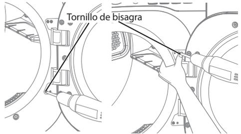
6. Extraiga la puerta de la cubierta de la secadora.
