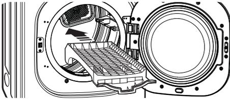
2. Asegúrese de que queda asentada uniformemente sobre el borde interior de la puerta y descance horizontalmente sobre el interior de la secadora.
