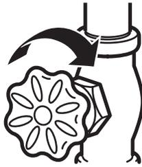
**9. CONECTE LA TUBERÍA AL REFRIGERADOR**
