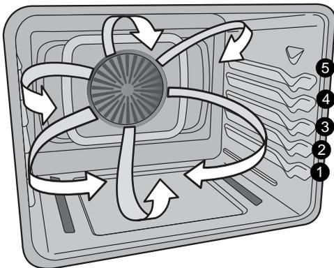
Figura 28: Circulación del ventilador de convección
