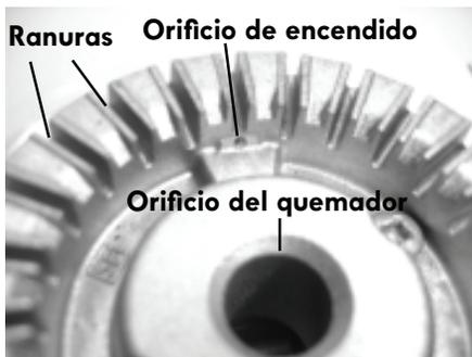
Figura 42: Cabeza del quemador de la cubierta
