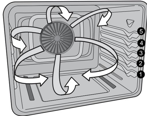
**Figura 21: Circulación del aire en la función de convección**
