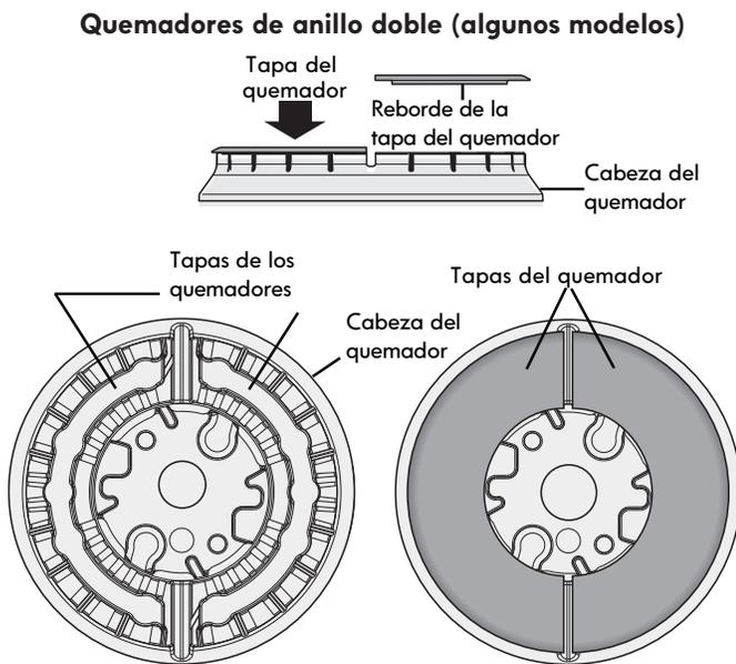
Figura 4: Cabeza del quemador doble usando dos tapas de quemadores
