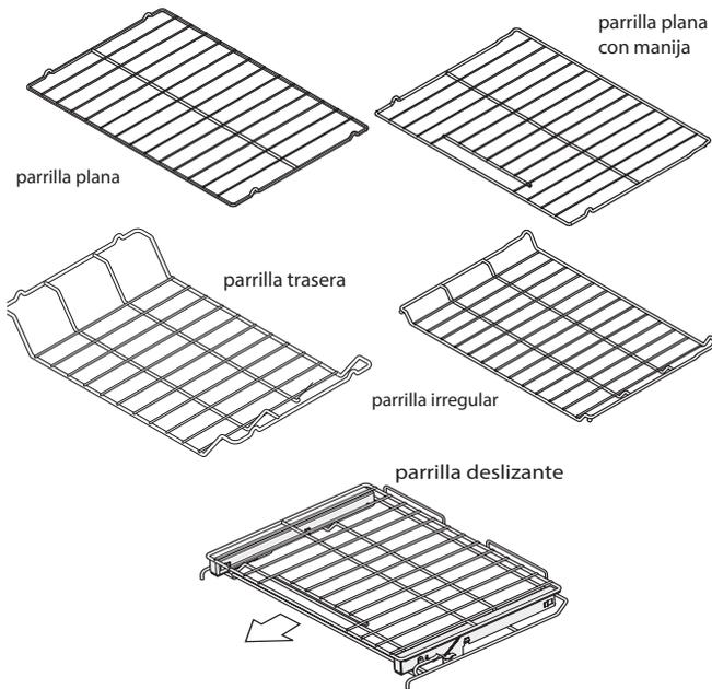
Figura 9: Tipos de parrillas del horno
