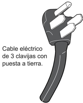
Cable eléctrico de 3 clavijas con puesta a tierra.
