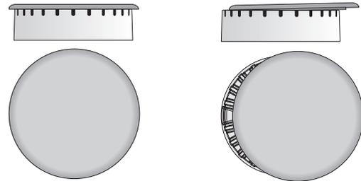
Colocación correcta de la tapa del quemador
