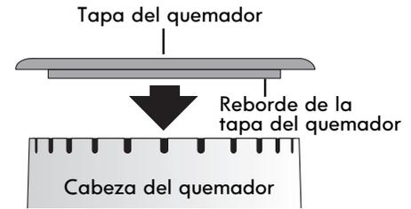
Figura 1: Tapa del quemador sobre la cabeza del quemador
