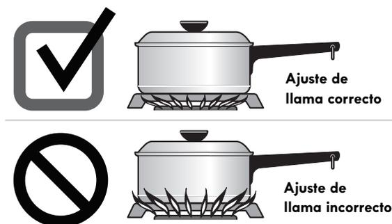
Figura 7: Cómo ajustar la llama para una cocción eficiente
