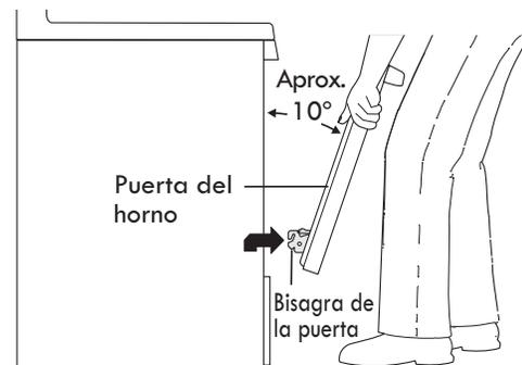
Figura 44: Cómo sujetar la puerta para su extracción
