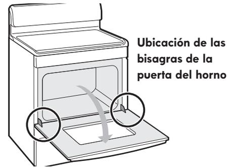
Figura 42: Ubicación de las bisagras del horno
