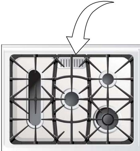
Figura 9: No bloquee la ubicación del respiradero del horno
