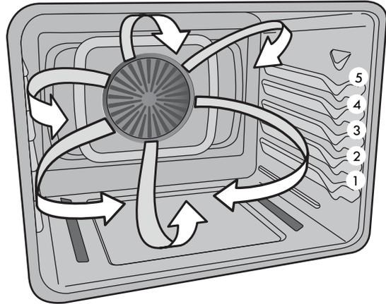
**Figura 22: Circulación del aire en la función de convección**
