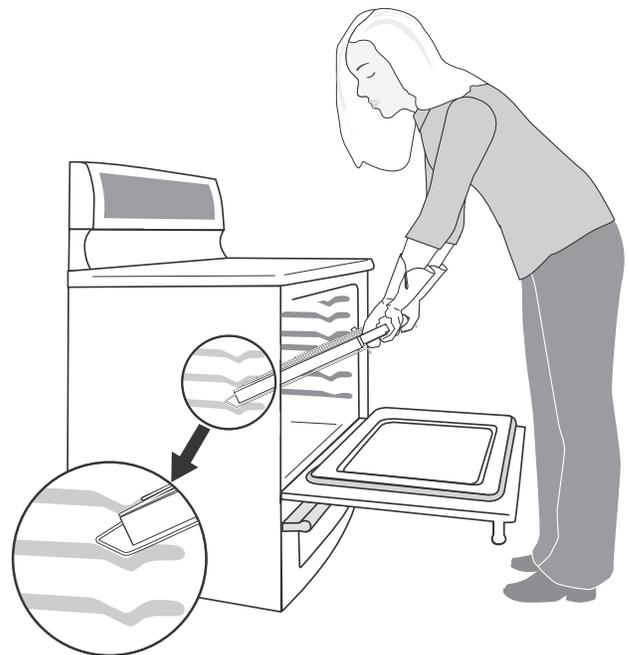
Figura 13: Reemplazo de la parrilla deslizante del horno
