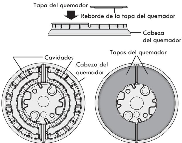
Figura 4: Cabeza del quemador doble usando dos tapas de quemadores
