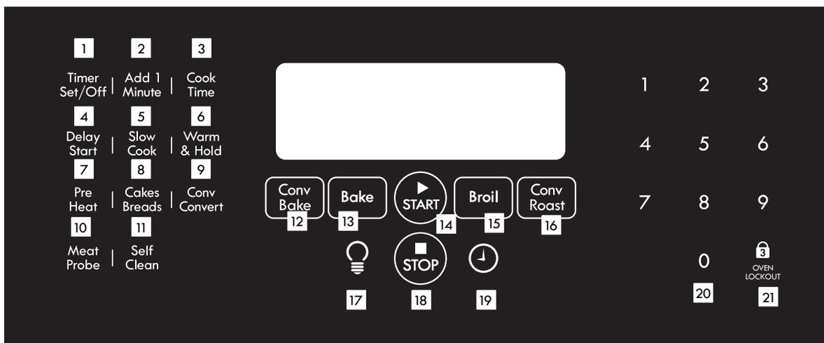
1. **"Timer Set/Off"** (encendido/apagado del temporizador): se usa para programar y anular el temporizador.
