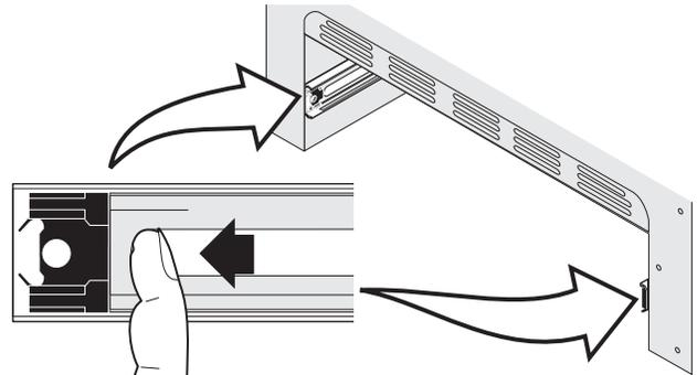
**Figura 50: colocación de los rodamientos**
