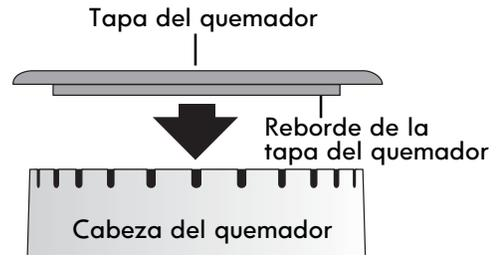
Figura 1: Tapa del quemador sobre la cabeza del quemador
