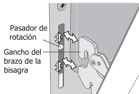
Figura 48: Ubicación del brazo de la bisagra y el pasador de rotación
