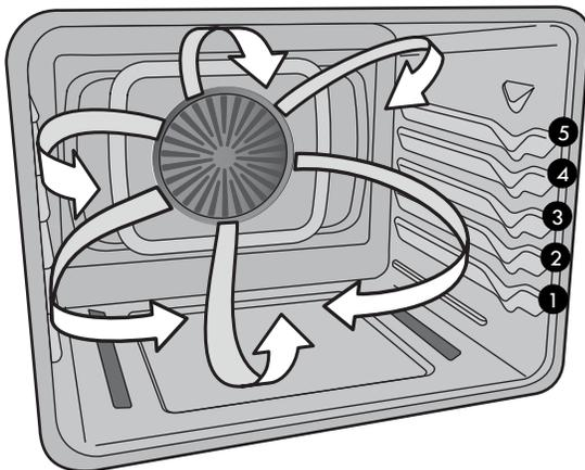
Figura 29: Circulación del aire en la función de convección
