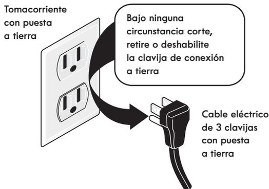
Vea las instrucciones de instalación que se incluyen con este electrodoméstico para obtener información completa sobre su instalación y puesta a tierra.
