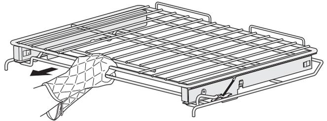
Figura 12: Extracción de la parrilla deslizante del horno
