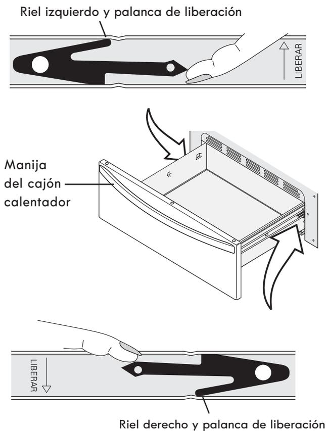
**Figura 49: desinstalación del cajón calentador**
