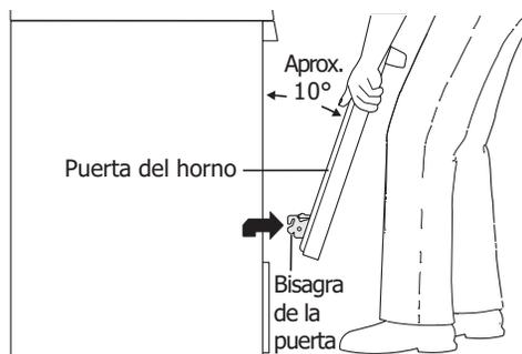
Figura 47: Cómo sujetar la puerta para su extracción
