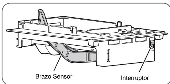
La máquina de hielo producirá 12 cubitos por ciclo, entre 90-130 cubitos cada 24 horas aproximadamente, dependiendo de la temperatura del congelador, la temperatura ambiente, el número de veces que se abra la puerta y otras condiciones de funcionamiento.
