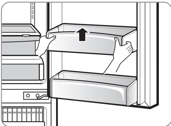
Los recipientes de la puerta son desmontables para una limpieza y ajuste sencillos. Sólo levante el recipiente y tire de él para retirarlo. Para volver a colocarlo, deslícelo sobre el soporte deseado y empújelo hacia abajo hasta que se detenga.
