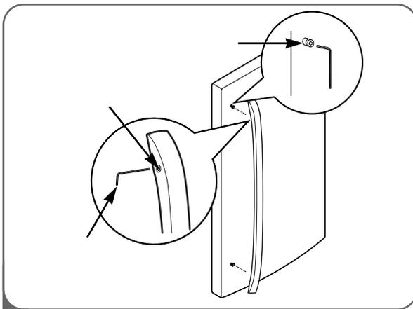
**1** Afloje los tornillos de fijación con una llave Allen de 2,5 mm (3/32") y retire la manija.
