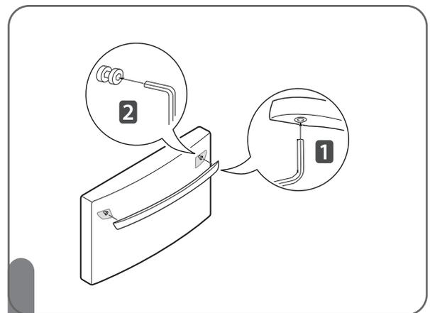
**2** Afloje los tornillos de presión **1** ubicados en la parte inferior de la manija con una llave Allen de 3,1 mm (1/8 pulg.) y retire la manija. Afloje los sujetadores de montaje **2** que conectan la puerta y la manija del refrigerador con una llave Allen de 1/4 pulg. y retire los sujetadores de montaje.
