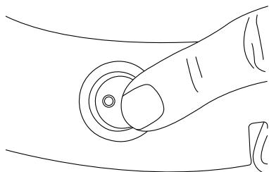
3. Allumez l'appareil en mettant l'interrupteur en position ON (marche). L'interrupteur se trouve à l'arrière de l'appareil. Une fois l'appareil allumé, l'interrupteur s'illuminera en rouge, et le bouton d'extraction du jus s'illuminera et clignotera en bleu.
