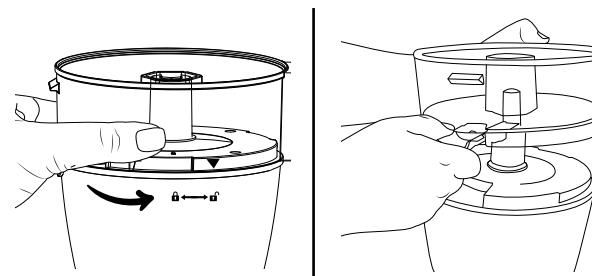
5. Retirez le réceptacle à jus (veillez à ce que le bec verseur soit placé vers le haut). Saisissez le réceptacle à jus puis faites-le tourner dans le sens inverse des aiguilles d'une montre jusqu'à ce que la flèche sur le réceptacle à jus s'aligne sur le dessin de verrou qui apparaît sur le bloc moteur. Soulevez le réceptacle à jus vers le haut pour l'enlever du bloc moteur.
