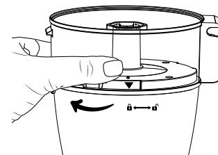
3. Faites tourner le réceptacle à jus vers la gauche jusqu'à ce qu'il soit en place et se verrouille et que le réceptacle s'aligne sur le dessin de verrou qui apparaît sur le bloc moteur.
