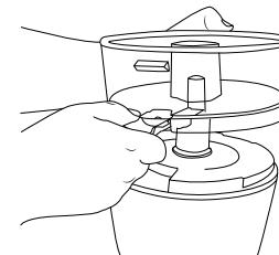
1. Installez le réceptacle à jus (E) sur le bloc moteur, en alignant le coupleur (M) sur le bloc moteur et le trou dans le réceptacle à jus.
