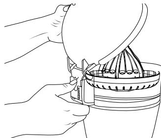
1. Retirez le couvercle en faisant glisser le bouton du déclencheur à charnière vers le bas et en enlevant le couvercle du réceptacle à jus.
