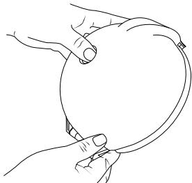
2. Retirez le cône de maintien en saisissant fermement le couvercle, la partie en forme de dôme vers le haut. Appuyez fermement sur le dessus du cône de maintien pour l'enlever du couvercle.
