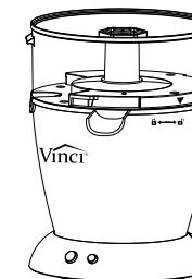
2. Lorsque vous regardez l'appareil de face, le bec verseur à verrouillage doit être placé juste à droite du logo Vinci.
