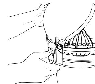
6. Installez le couvercle (A) sur le réceptacle à jus en faisant glisser le bouton du déclencheur à charnière (L) vers le bas, en alignant les languettes de la charnière (I) sur les trous du déclencheur, puis en faisant glisser le couvercle pour qu'il se mette en place. Fermez le couvercle.
